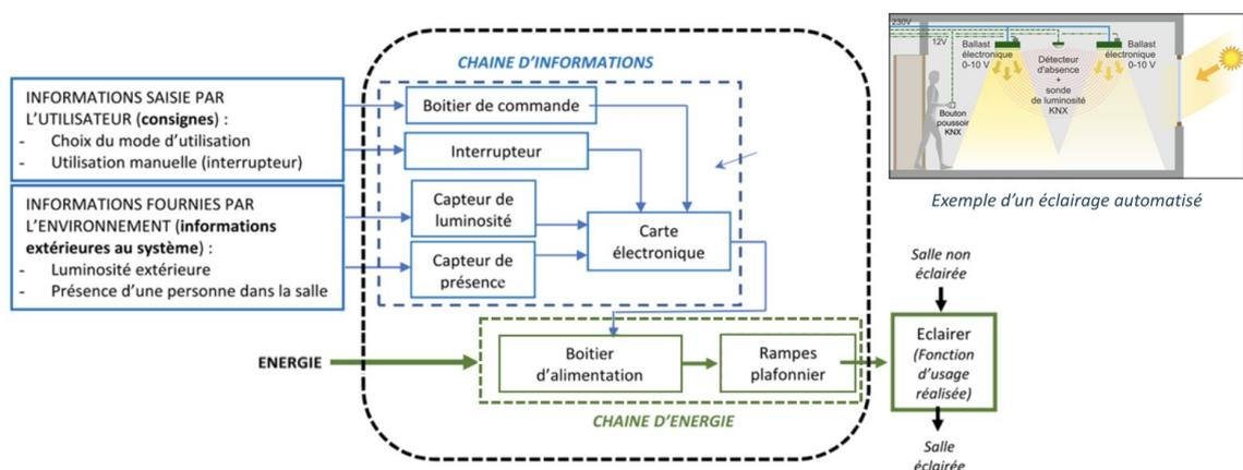
La **représentation fonctionnelle d'un système technique** permet de **décrire et expliquer le fonctionnement** par un **schéma**.
